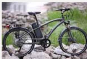
Une autonomie de 100km, moteur japonais 250W, 6 niveaux d'assistance, dérailleur shimano 9 vitesses, freins avant et arrières hydrauliques à disque TEKTRÖ, selle italienne à suspension, pédales antidérapantes, fourche à suspension hydraulique. Sportif et pas seulement le dimanche !
