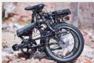
Une autonomie de 50km, moteur japonais 250W, 6 niveaux d'assistance, dérailleur hub nexus shimano 7 vitesses, cadre hydroformé de 38 cm, selle italienne à suspension, pédales pliables à roulement étanche, Pneus 20 pouces Schwalbe Energizer Plus avec protection anti-crevaisson 3mm Green Guard. Pratique, Eric !
